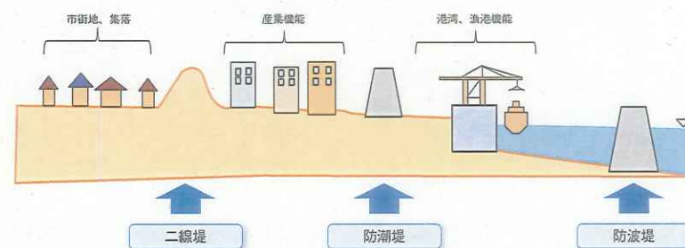
図表2 防波堤・防潮堤、二線堤のイメージ
