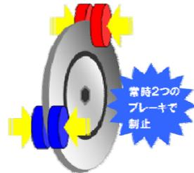
常時作動型の二重ブレーキを新規設置(巻上機を交換)
