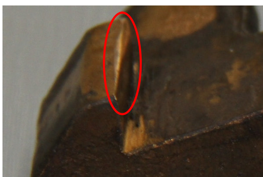
固定側フック 先端部に著しい摩耗が見られる
