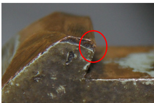
移動側フック 先端部に著しい摩耗が見られる
