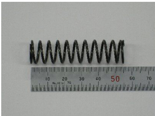
図 3-1 固定側ばね (自由長 55 mm)
