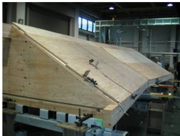
写真 6. 屋根構面の破壊時の全景
