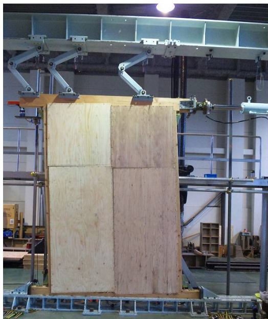
写真 1. 耐力壁の強度試験
