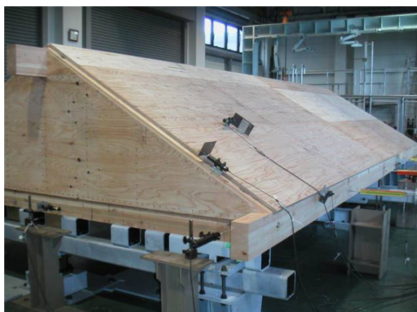
写真 3. 屋根構面の軸組全景
