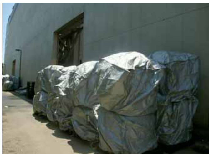
写真 4-1 下水処理場における脱水汚泥の保管例
