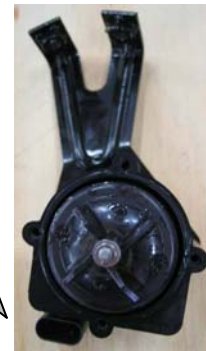
基準不適合発生箇所 ターボ チャージャー冷却用 補助クーラント ポンプ
