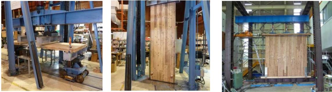
写真 試験実施状況（左：曲性能実験 中：座屈実験 右：水平加力実験）
