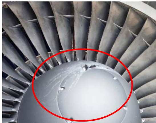
↑ 左側エンジン前面における残留物
