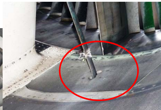
↑ 左側エンジン内部に鳥の羽が付着した状態。 (ブレードは破断していない。)
