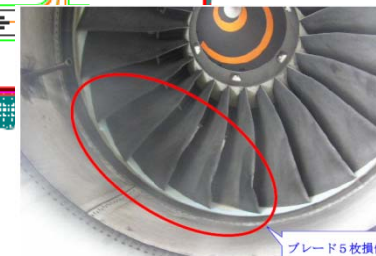
右エンジンのブレード損傷
