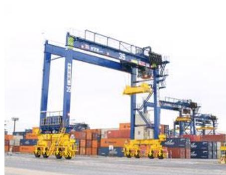
電力回収装置付トランスファークレーン
