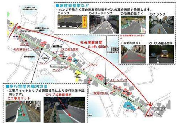
全幅が7mを、社会実験で車道幅4mに狭める一方、両側の歩道をそれぞれ1.5mに拡幅した。路側線には、突起の付いたリブ式の路面表示を採用し、歩行帯には緑色の工事用マットを敷設して歩行帯が目立つようにし、車の運転者に歩行帯の存在を視覚的に訴えている。
