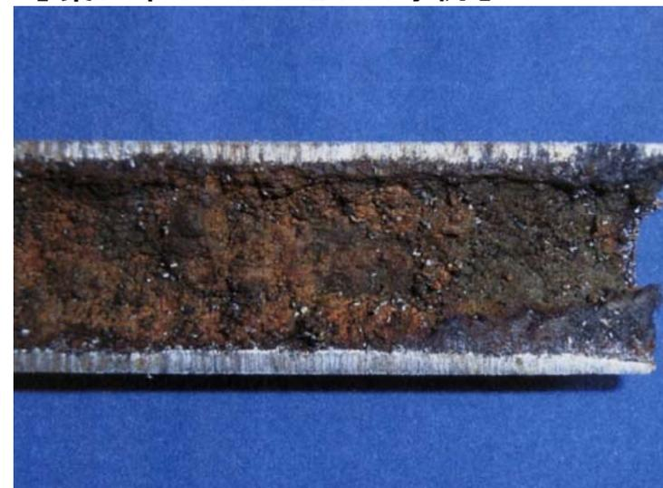
住戸内給水管の断面図。錆こぶがひどい。
