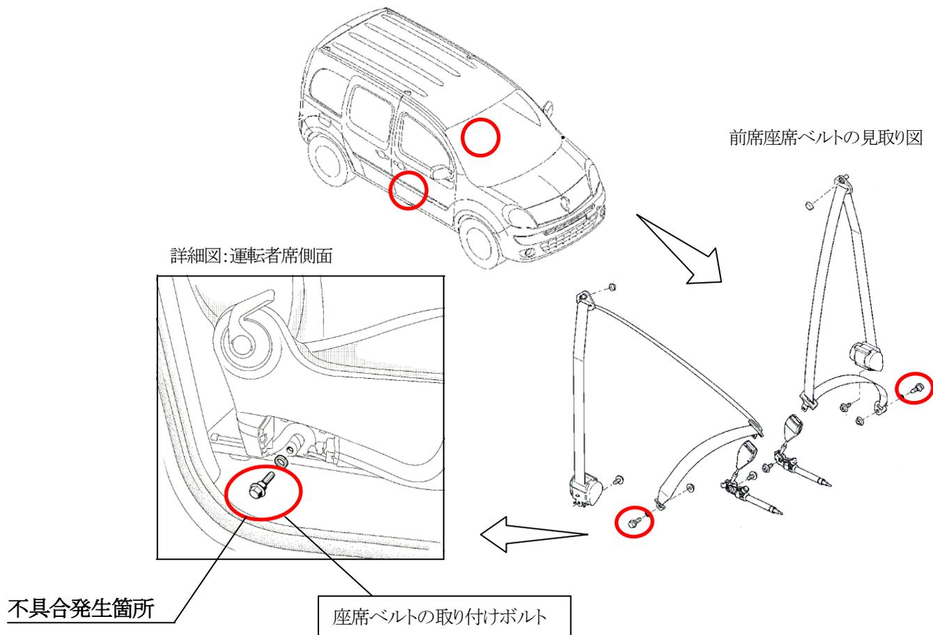
前席左右両側の座席ベルトの取り付けボルトにおいて、製造時に緩み防止剤が塗布されていなかった為、使用過程において当該ボルトに緩みが発生し、最悪の場合、衝突時等に座席ベルトが乗員を拘束できないおそれがある。
