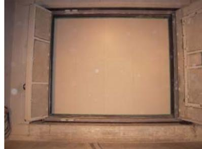
遮音試験体（試験体 No.2）
