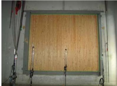
遮音試験体（パネル単体：試験体 No.1.）
