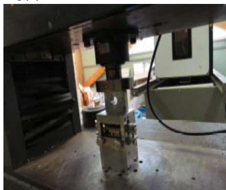
Fig(7) 接着性能試験
