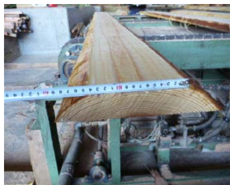
Fig(2) 側板末・元寸法調査
