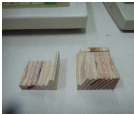
Fig(8) 接着性能試験
