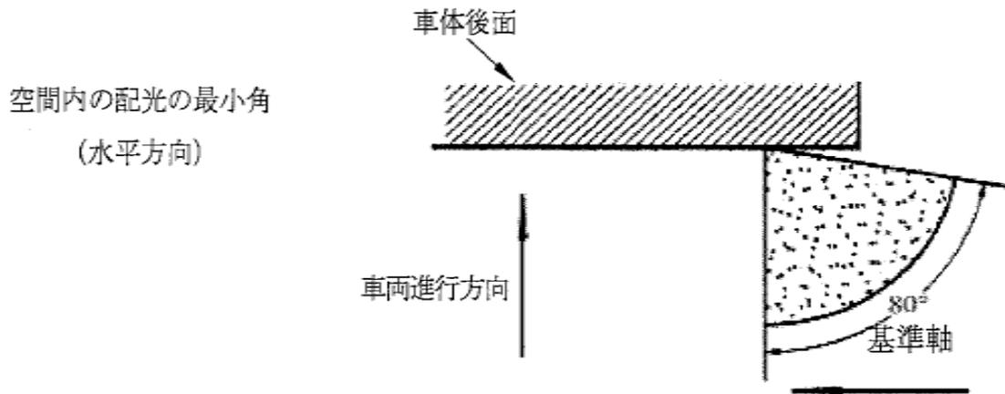
(注) 上図に示した角度は、車両の右側に装着する場合を示す。
