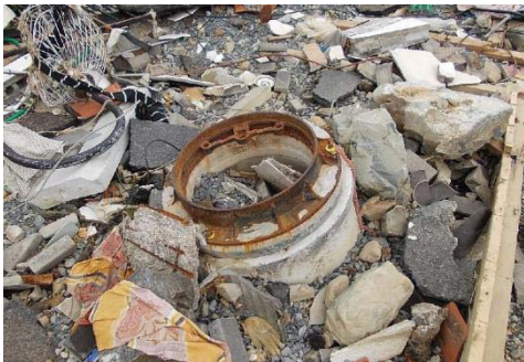
宮城県女川町（蓋の流出）
