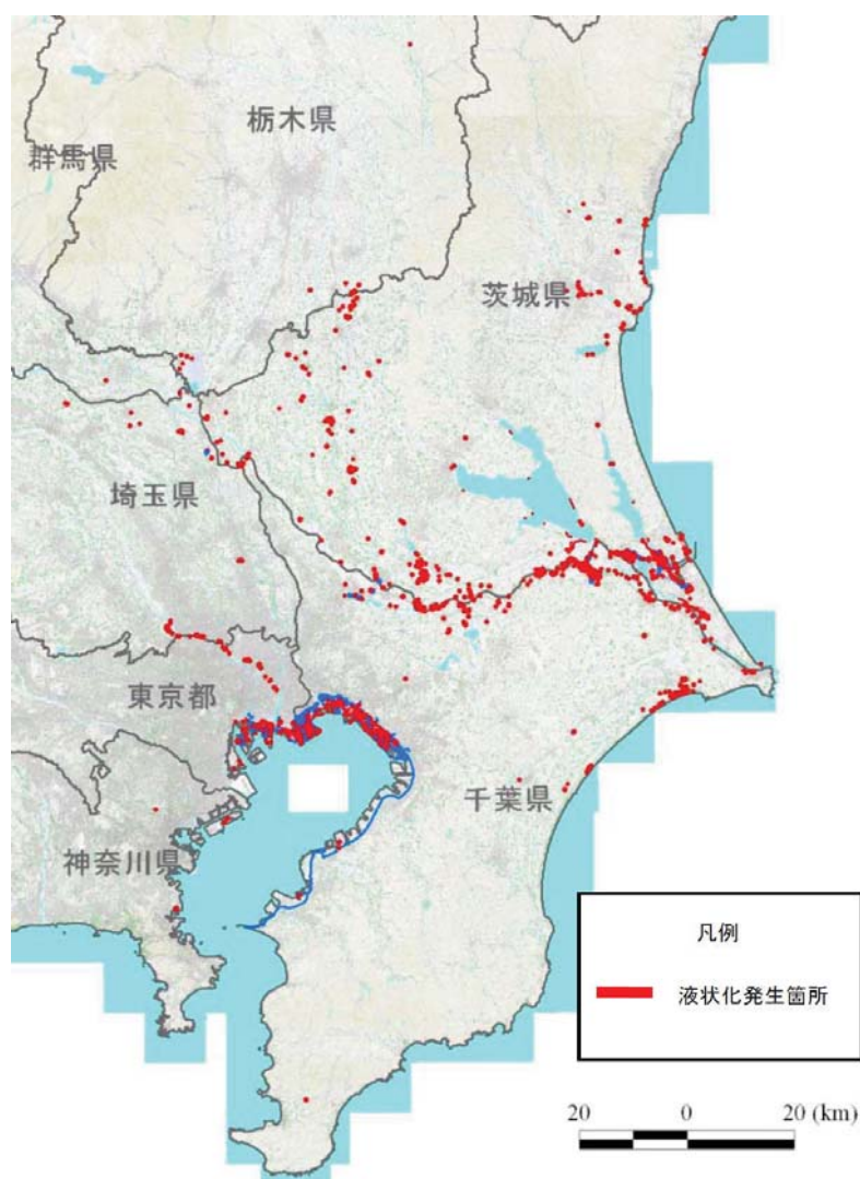
図 I-1-10 関東地方の液状化発生箇所の分布
