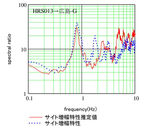
図-1.2.3.2 常時微動H/V スペクトルを用いたサイト増幅特性の推定例（振幅補正なし）
