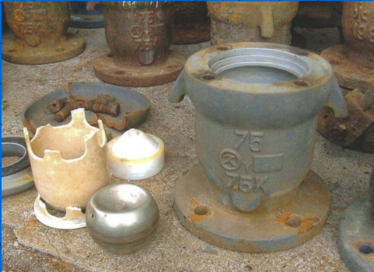
破損した空気弁
