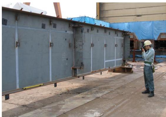
写真二 デジタルカメラによる計測
