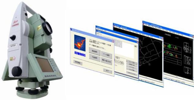
写真－1 ひび割れ計測システム
