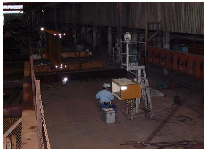
写真-4 部材自動計測（鋸桁）
