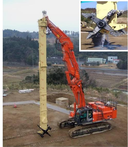
写真一 1 改良長 13m 施工機
