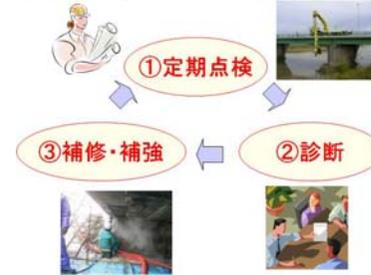
橋梁点検～補修・補強の流れ
