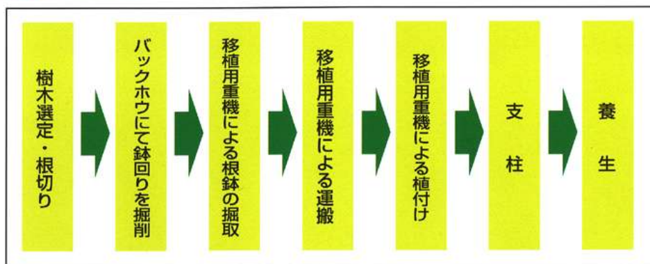
高木重機移植の施工手順（日本道路公団等パンフレット）
