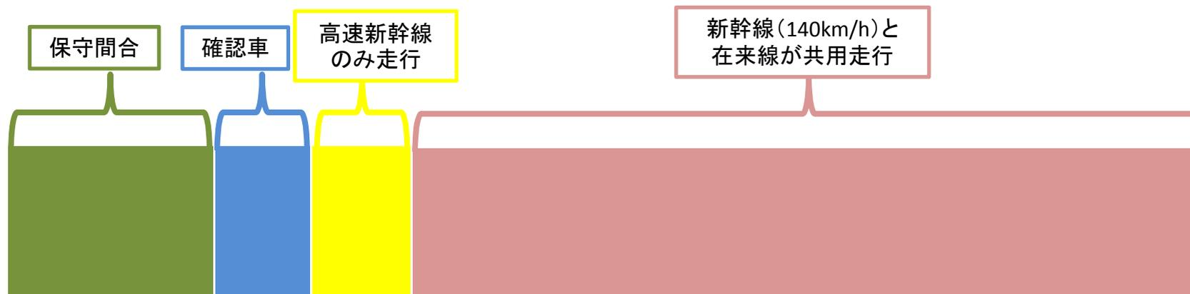
【新幹線・在来線混在の合間の時間帯に新幹線260km/hを走行させる場合】
