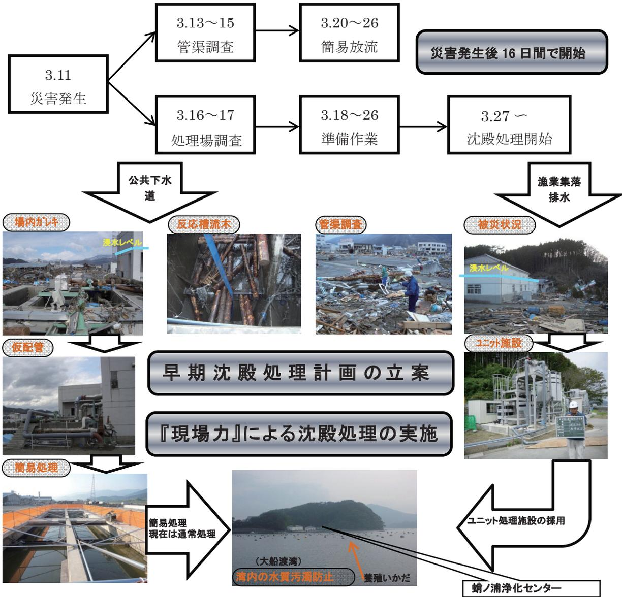
大船渡市では、公共下水道区域の65.4%が浸水し、処理場は機能停止となり、漁業集落排水施設の5地区も甚大な被害を受けました。被災後ただちに未浸水区域の避難所・病院施設を受持つ管渠の調査及び処理場の被害調査を実施し、管渠の流下機能の確保、池施設の状態を確認して、沈殿処理が可能であると判断し、復旧作業を開始しました。
