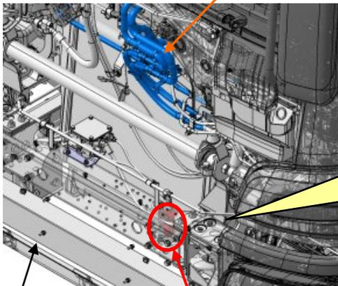
前軸の衝突被害軽減ブレーキ用バルブ(調整弁)
