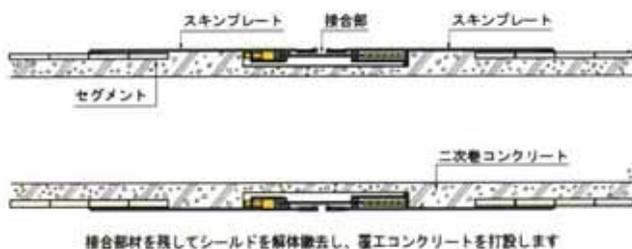
接合部材を残してシールドを解体撤去し、覆工コンクリートを打設します
