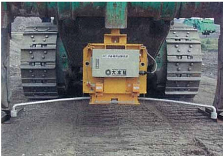
ブルドーザへの試験装置の取付状況
