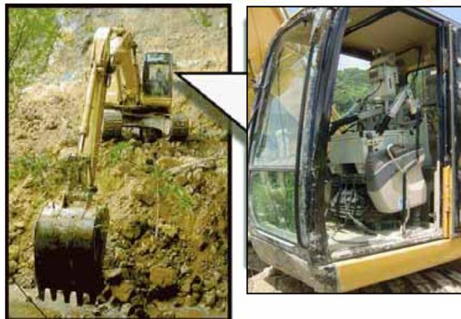
「簡易遠隔操縦装置(ロボQ)」
