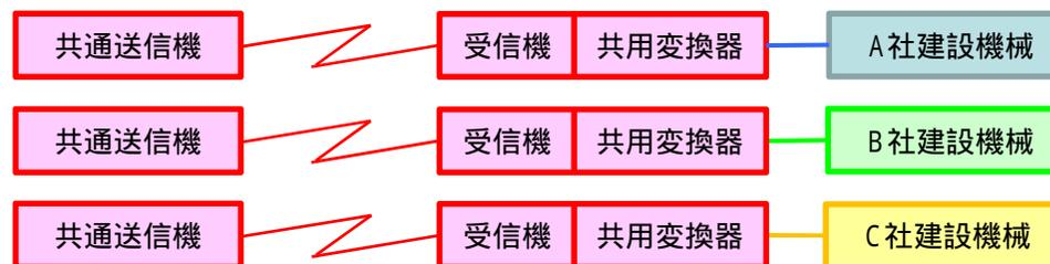
「共用変換器搭載型無人化施工システム」
