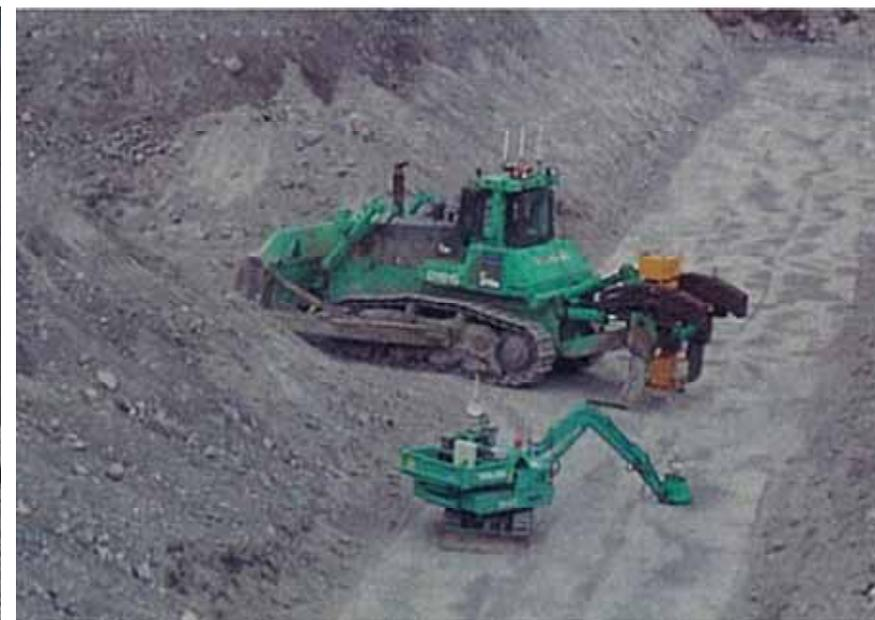
無人化施工区域での実証試験状況
