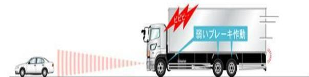
ドライバーが前方の車両に気づかない場合は、音によりドライバーにブレーキ操作を行うように促す。
