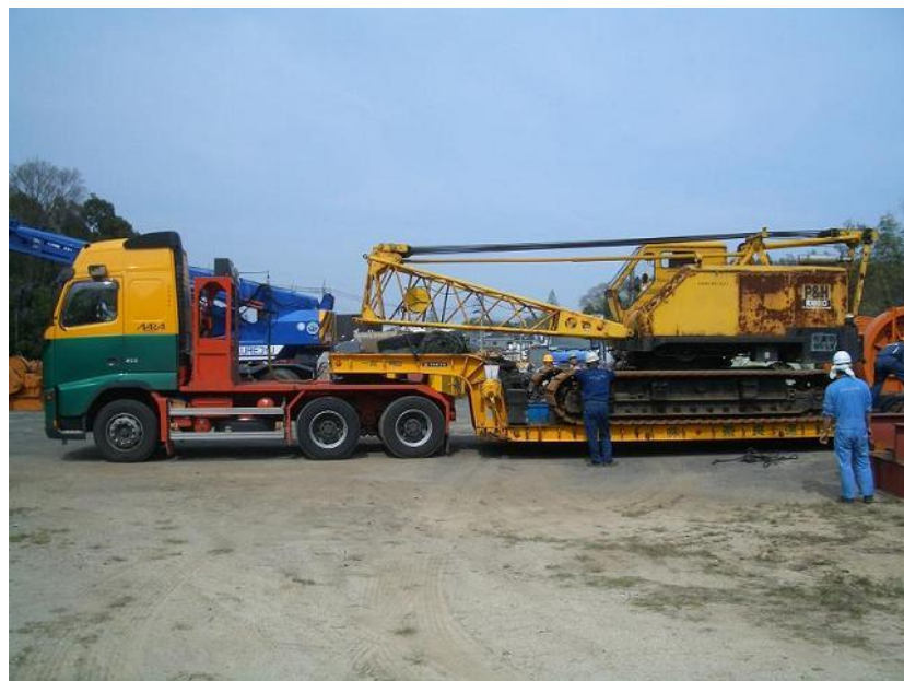
建設機械の陸送
