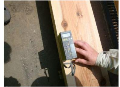
含水率測定。乾燥が完了したかどうか含水率計にて測定する
