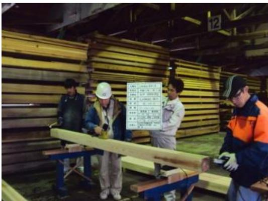
材料検査：含水率・強度測定
