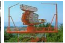
空港監視レーダー (空港周辺の航空機の監視)
