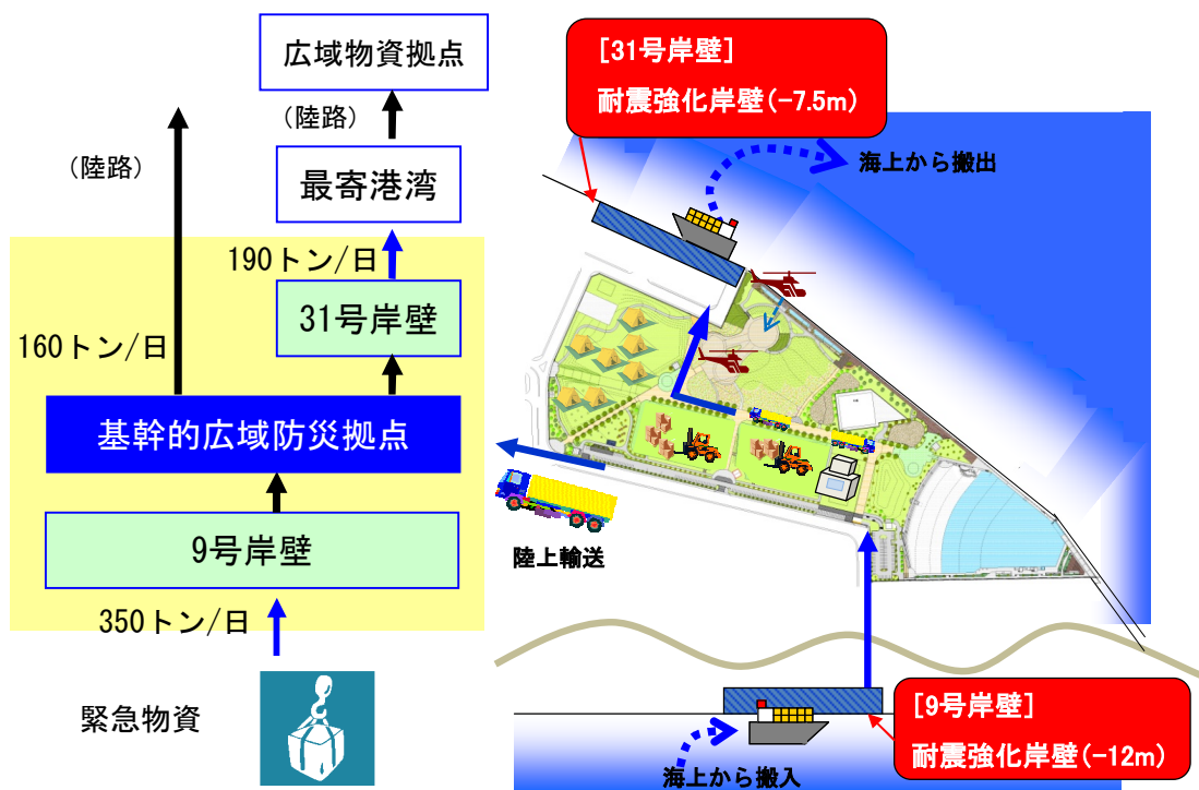
図 3.3-12 川崎港東扇島地区基幹的広域防災拠点での輸送方法（イメージ）
