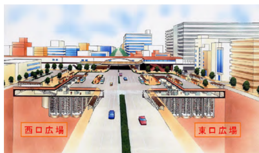
駅前広場地下を機械式駐輪場として利用 〔葛西駅東口・西口駐輪場〕
