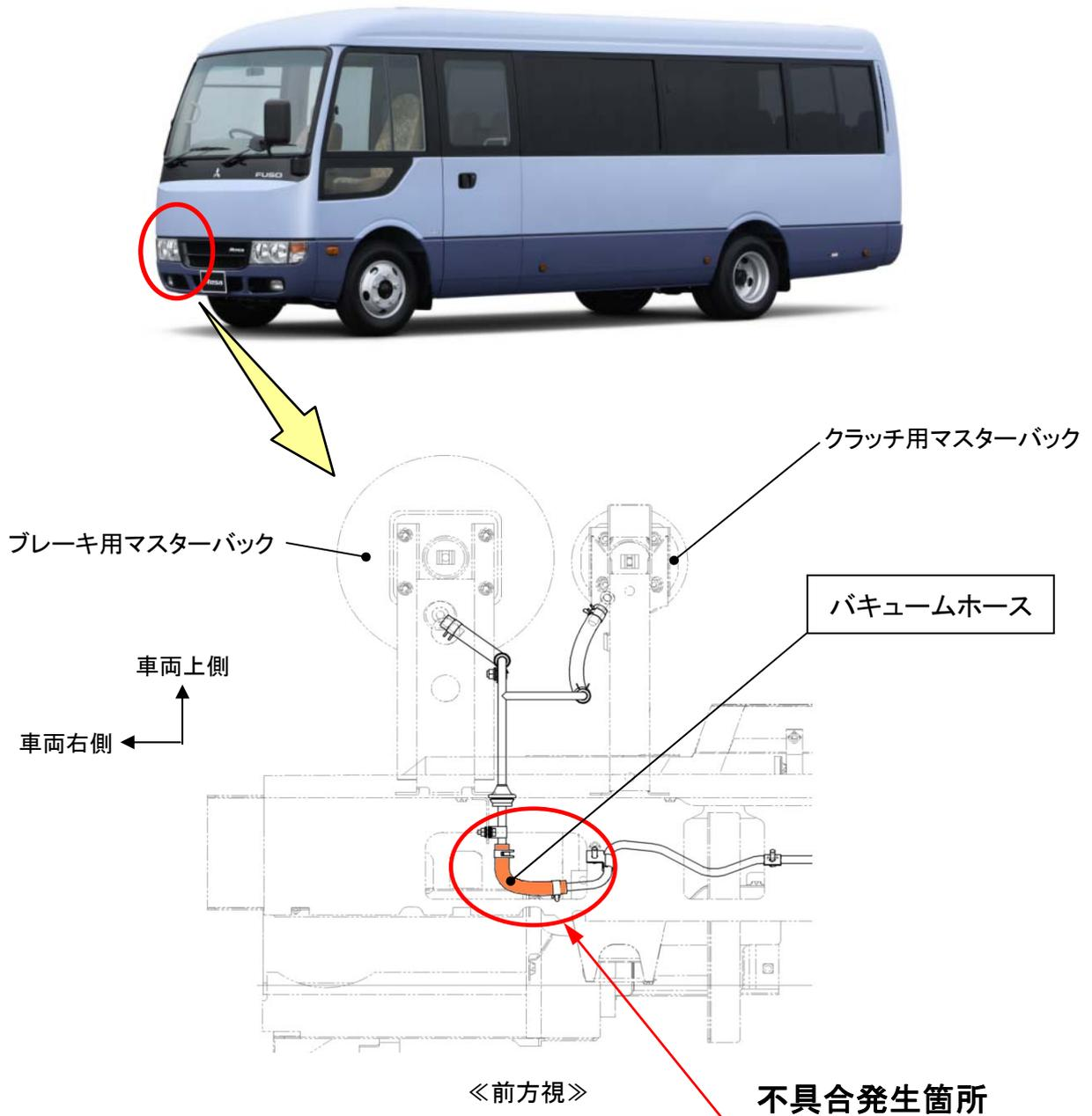
小型バスにおいて、バキュームホースの選定が不適切なため、当該ホースに潰れが生じるものがある。そのため、そのままの状態で使用を続けると、ブレーキウォーニングランプが点灯し、ブレーキとクラッチの操作力が増加するおそれがある。
