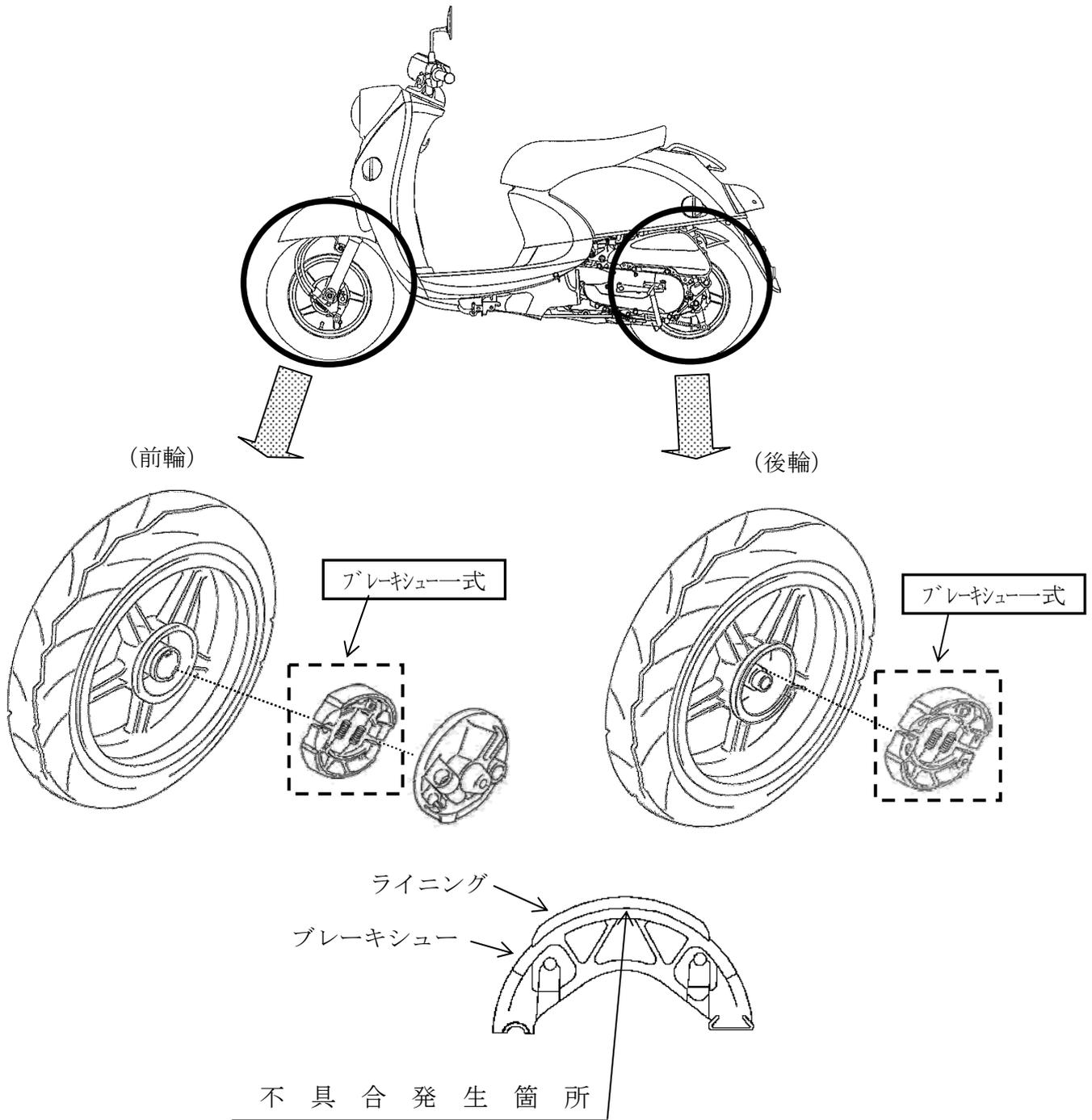
ドラム式の制動装置において、ブレーキシューの製造が不適切なため、ブレーキシューとライニングの接着が不十分なものがある。そのため、ブレーキ操作を繰り返すとライニングが剥がれ、制動時にドラムとシューの隙間に噛み込み、意図した以上の制動力が加わることがあるため、低速時に走行安定性を損なうおそれがある。
