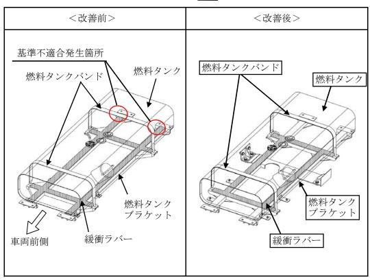
路線バスの燃料タンクにおいて、燃料タンクの緩衝ラバーの形状が不適切なため、燃料タンクバンドを締め付けると、燃料タンクの端部に過大な応力が発生することがある。そのため、そのままの状態で使用を続けると、車両走行時の振動等により燃料タンクに亀裂が入り、最悪の場合、燃料が漏れるおそれがある。
