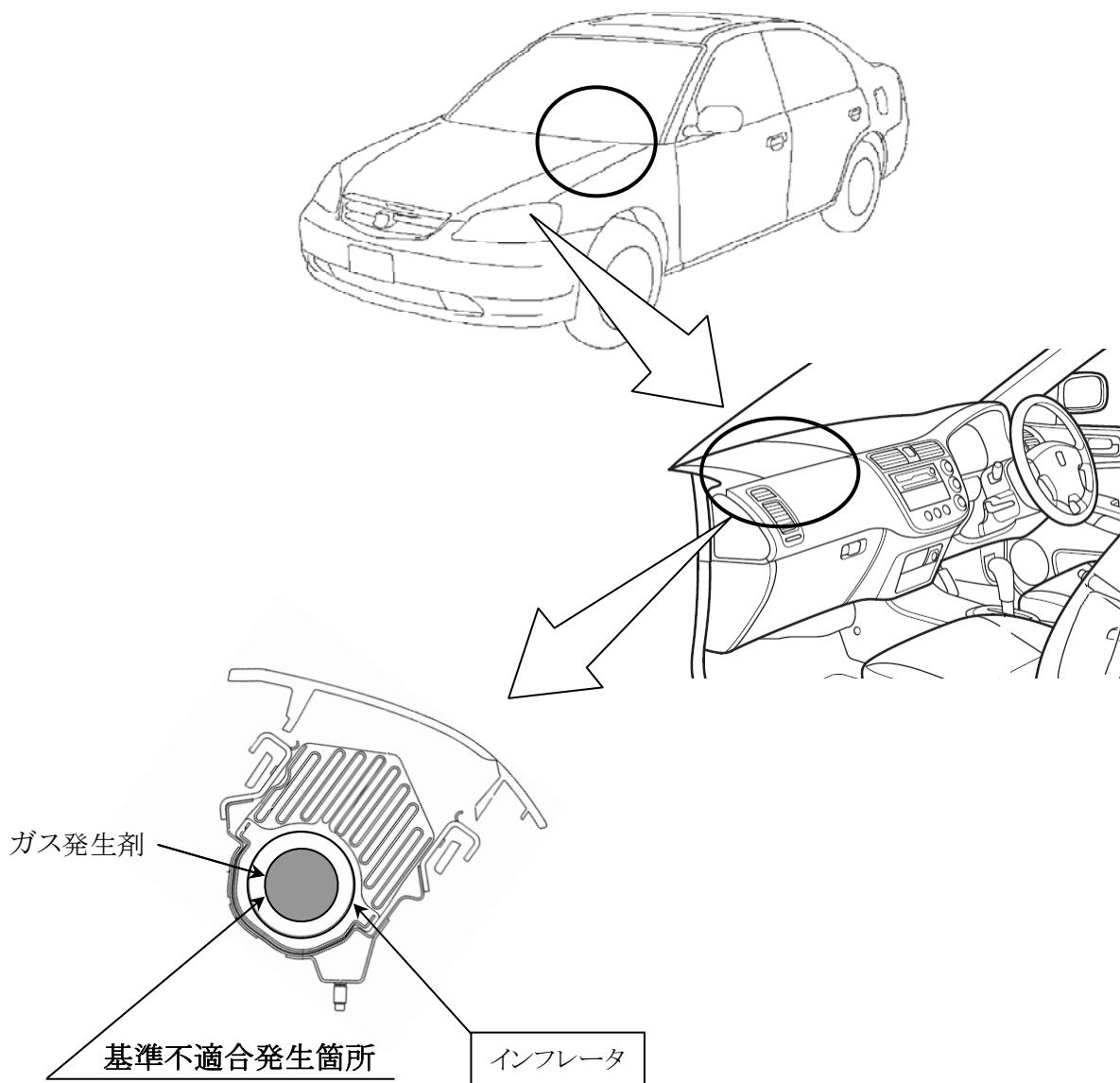
助手席用エアバッグのインフレータ（膨張装置）において、ガス発生剤の成型工程が不適切又は成型後の吸湿防止措置が不適切なため、密度が不足したガス発生剤が組み込まれたものがある。そのため、エアバッグ展開時にインフレータ内圧が異常上昇し、インフレータ容器が破損して飛び散り、出火するおそれがある。
