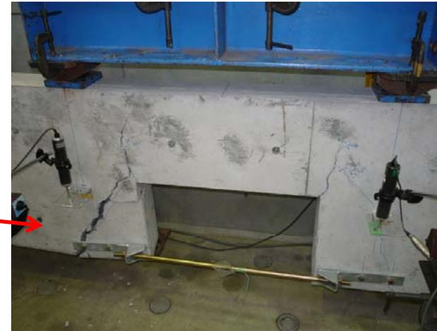
写真 形状4の補強 破壊状況
