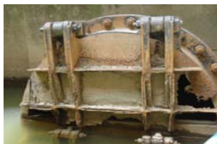
ポンプ設備の逆流防止弁の破損状況
