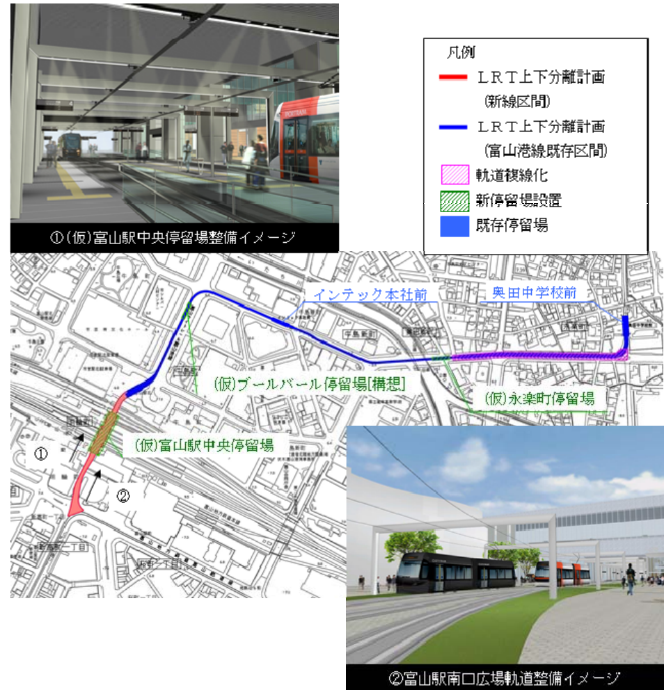
図 路面電車南北接続事業概要
