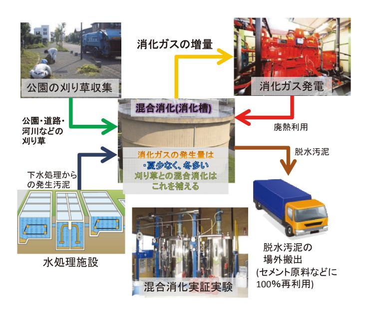
新潟市では、平成25年1月より消化ガス発電を本格稼働しており、消化槽から発生する消化ガスのほぼ全量を消化ガス発電の燃料とし、発電した電力は場内で使用しています。また、発電する際にガスエンジンから発生する熱を消化槽の加温に利用しています。
