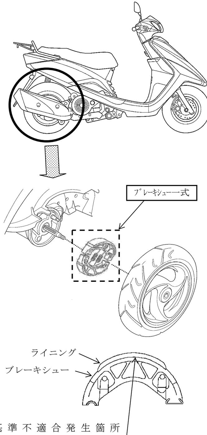
ドラム式の制動装置において、ブレーキシューの製造が不適切なため、ブレーキシューとライニングの接着が不十分なものがある。そのため、ブレーキ操作を繰り返すとライニングが剥がれ、制動時にドラムとシューの隙間に噛み込み、意図した以上の制動力が加わることがあるため、低速時に走行安定性を損なうおそれがある。
