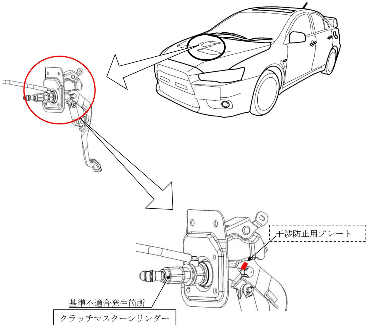
クラッチマスターシリンダー溶着部の強度が不足しているため、クラッチマスターシリンダーが破損し、フルードが漏れるものがある。フルードが漏れた場合、クラッチ操作ができなくなるため、変速ギヤのチェンジができず、また、停止後に発進できなくなる。
