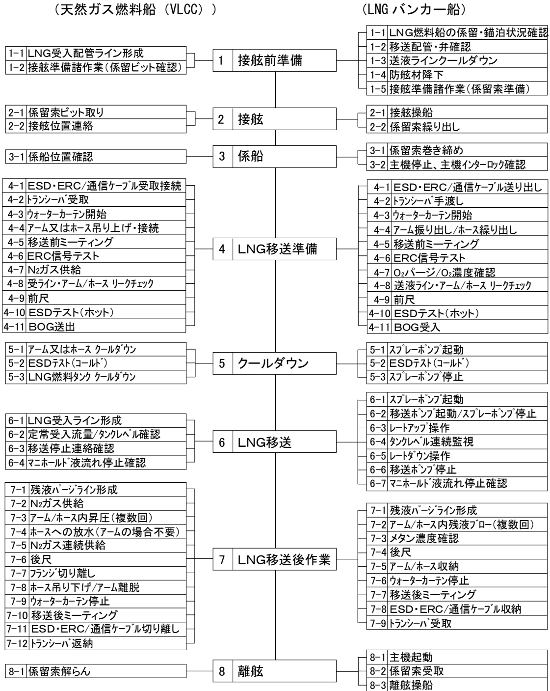
図 ⑤-1.3 LNG 移送作業フロー (例)
