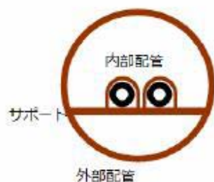
二重管概念図 (サポート部断面)
