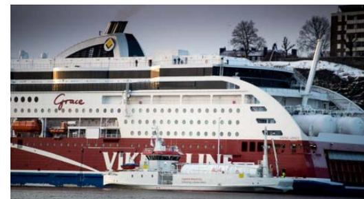
ストックホルムでのStS方式LNG燃料移送
