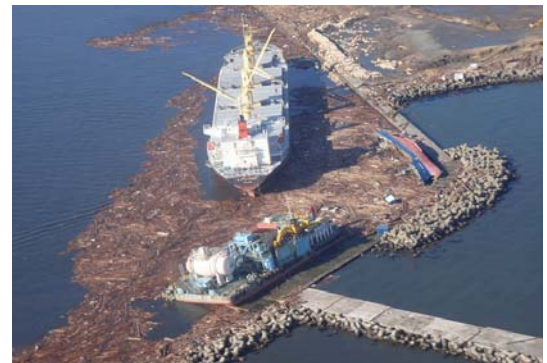
東日本大震災による船舶被害 (石巻港)
