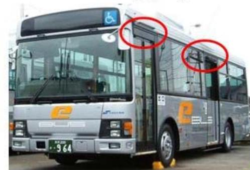
車両に赤外線センサーと車内コンピュータを設置し
