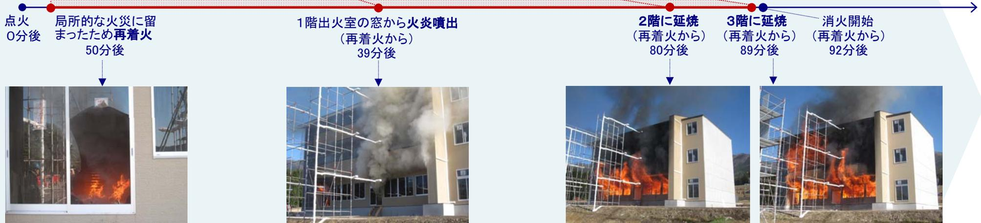
⇒ バルコニー・ひさし、防火壁は、延焼防止に関し一定の効果が確認され、今後、詳細な分析が必要ではあるが、H23予備実験で見られた早期の延焼拡大について解決の目途が付けられた。今回のH24準備実験の結果を踏まえ、基準化に向けた実験(H25本実験)を実施する予定。
