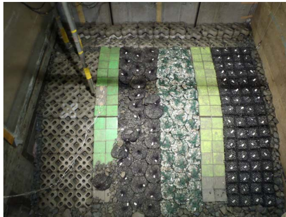
図Ⅲ-4.5 流速の時系列と実験後の被覆工の様子（上図において、赤線がV7における水平流速）
