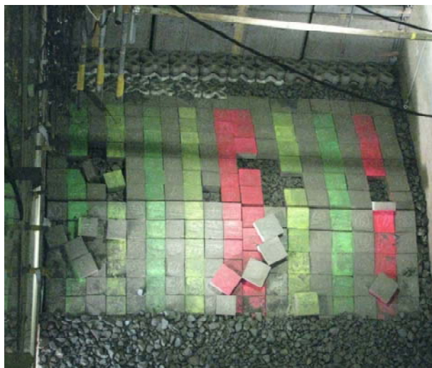
図Ⅲ-4.13 方塊ブロック（2トン型，および3トン型）を用いた実験結果
