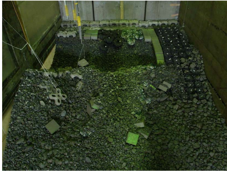
図Ⅲ-4.8 流速の時系列と実験後の被覆工の様子（上図において、赤線がV7における水平流速）
