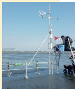
CO 2 吸収速度を観測する装置
