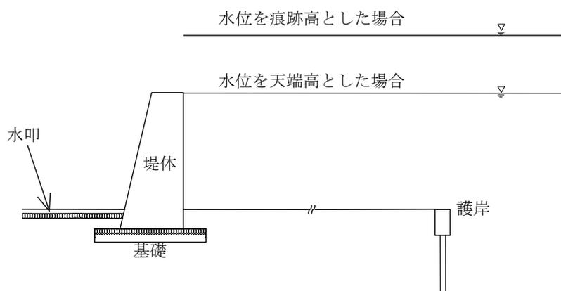
図-I-3.11 津波高さから断面の安定性を検討する概念図
