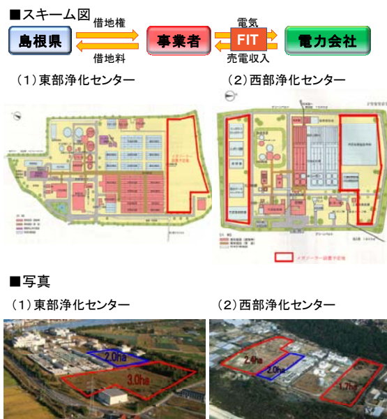
図 10 施設上部や敷地の貸付による太陽光発電事業の例
